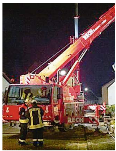
Der Führerstand, von dem der Kran manövriert wird.
